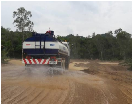
รูปที่ 5 การฉีดพรมน้ำบริเวณเส้นทางขนส่งแร่และบริเวณหน้าเหมือง
